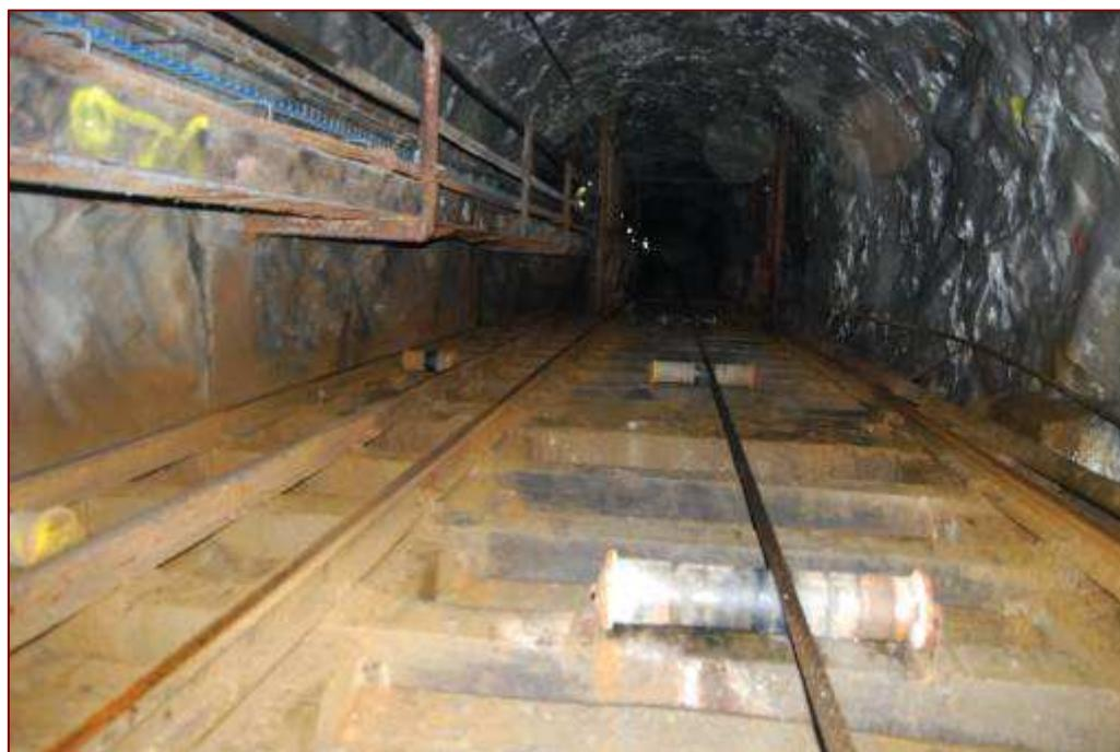
*Foto 5.8-5: piano inclinato sul quale si aprono gli accessi ai livelli di coltivazione*
