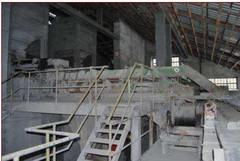
*Foto 5.5-6: ambiente interno ricoperto di uno strato di polveri di lavorazione; si notano i passaggi pedonali su scalette metalliche e mancorrenti*
