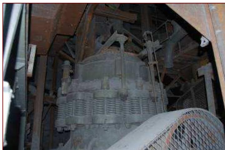
*Foto 5.5-5: macchina per la frantumazione del minerale*
