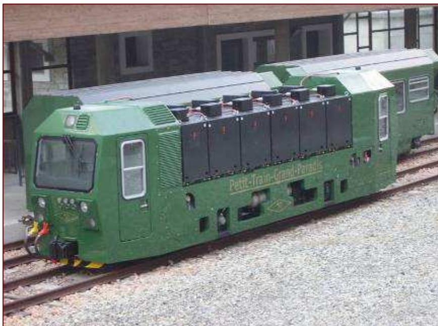
*Foto 5.4-10: locomotore V38 alla stazione di Cogne; si noti la grande massa di batterie al piombo che occupano tutto il settore centrale del corpo macchina.*
